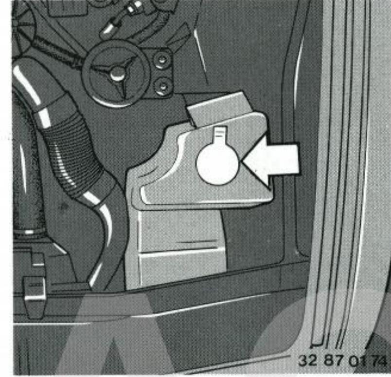
**Vorratsbehälter der Reinigungsanlage für Scheinwerfer und Nebelscheinwerfer\* – BMW 730i Sechszylinder**
